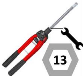
En caso de necesitar desmontar el tirante interior, utilizar una llave fija de número 13.
