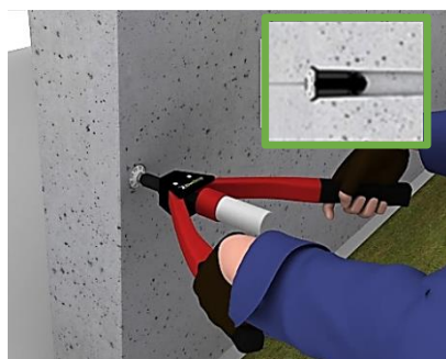
2. Embocar en el orificio a sellar
